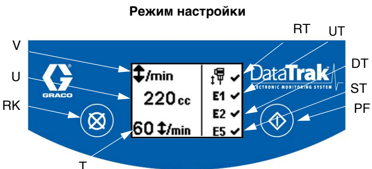
Рис. 5. Устройства управления модулем DataTrak и их индикаторы
